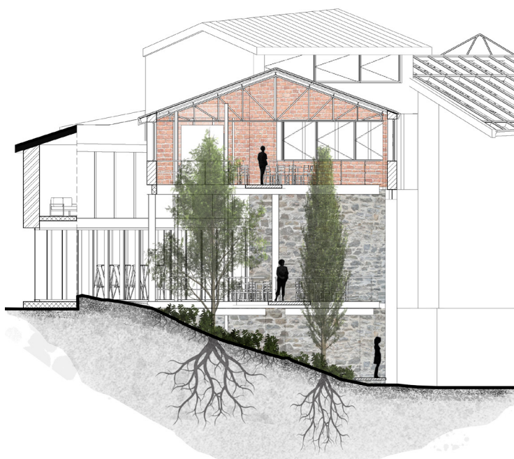
Coupe détail de la Fabrique
